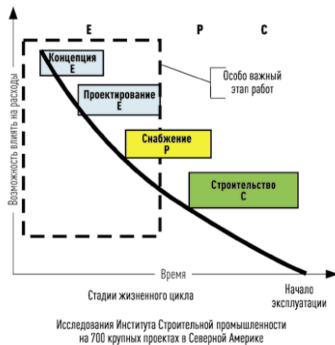
Рисунок 1. Воздействие на затраты вложений в проектирование объектов, в том числе шельфовых. Распределение затрат и уровень воздействия недоработок на стоимость [3]
