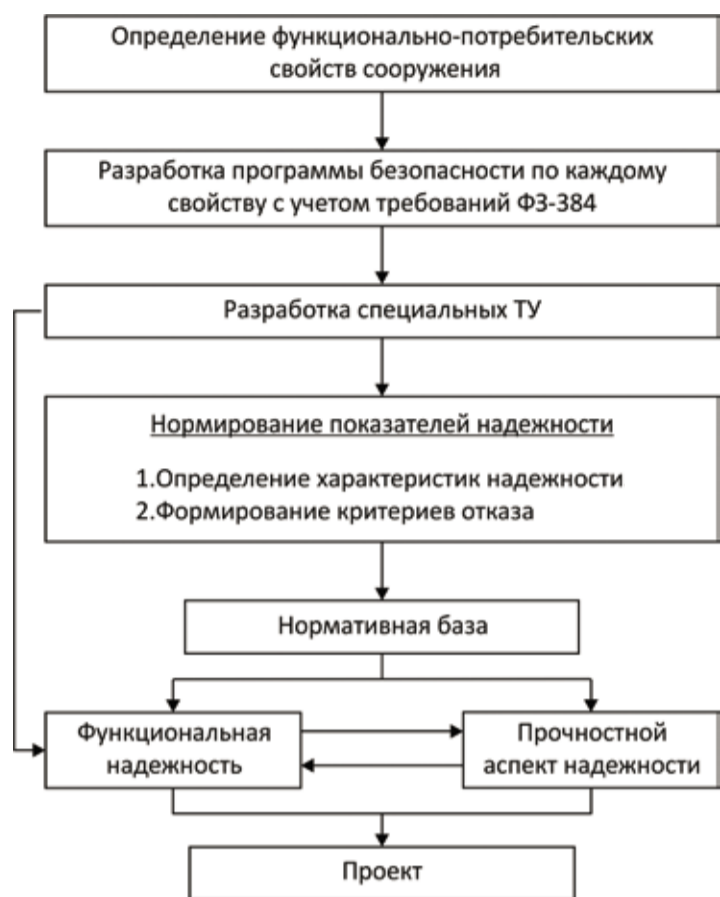
Рисунок 2. Алгоритм разработки требований к проекту по принципу ГЧП
